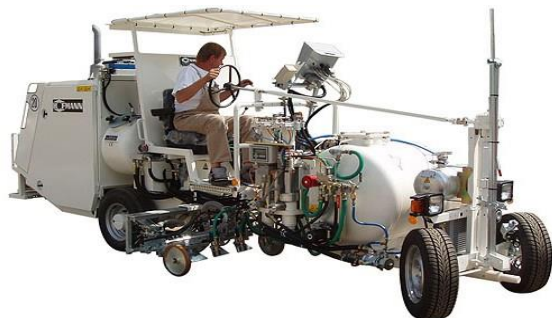
Слика 3. Машинско нанесување на боја на коловоз
