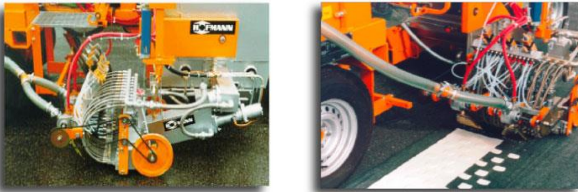
Слика 6. Принцип на нанесување на термопластични ознаки на коловоз ( Екструдер )
