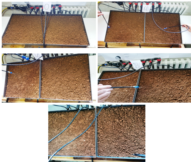
Слика 12. Ерозивни промени на третирана косина (десно) и природна косина (лево), Q=12 л/час, а) 0 мин., б) 60 мин., в) 120 мин., г) 180 мин., д) 210 мин.
