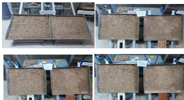
Слика 11. Ерозивни промени на третирана косина (лево) и природна косина (десно), Q=10 л/час, а) 0 мин., б) 60 мин., в) 120 мин., г) 180 мин.
