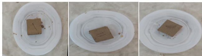
Слика 6. Примероци од опит на директно смолкнување на полимерно третирана почва
