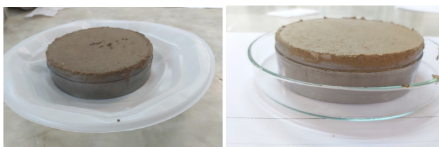
Слика 8. Примероци од едометарски опит на а) третирана почва и б) природна почва
